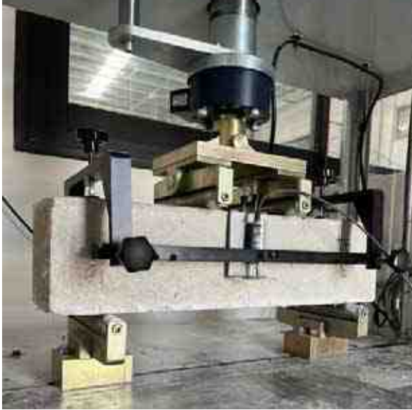
Şekil 2. ASTM C 1609 Test Düzeneği
