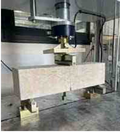
Şekil 1. EN 14651 Test Düzeneği
